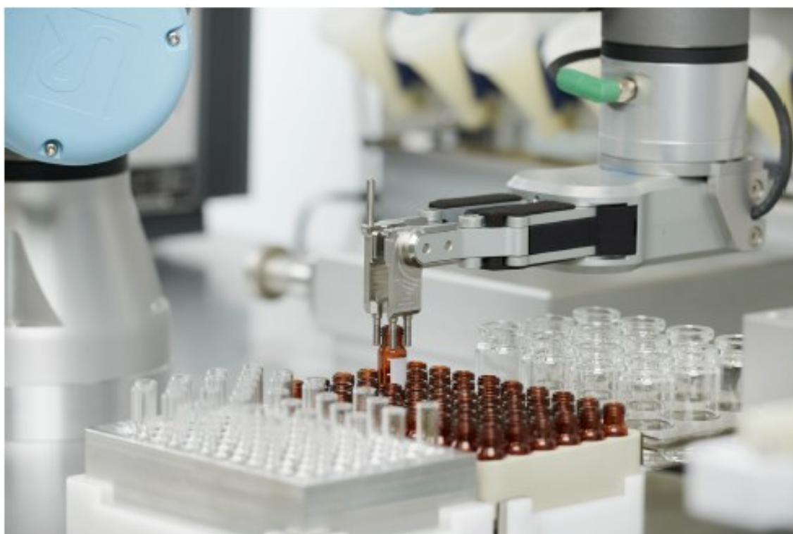
図2：各種の容器サイズに対応 (1mLチューブ、2, 4, 8, 10, 20, 40mLバイアル)
