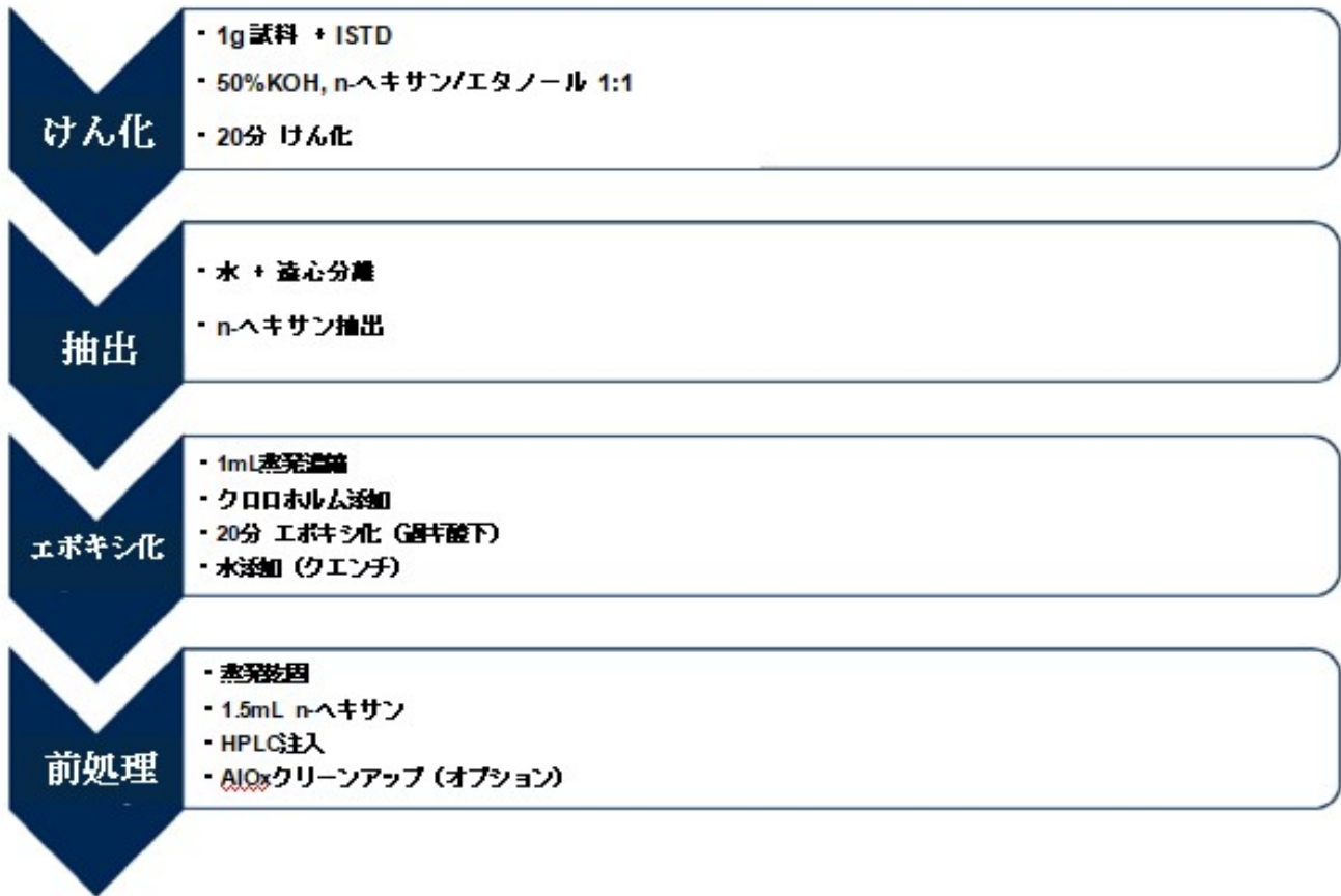
図 6: 食用油脂中MOSH/MOAH分析 自動化ワークフロー
